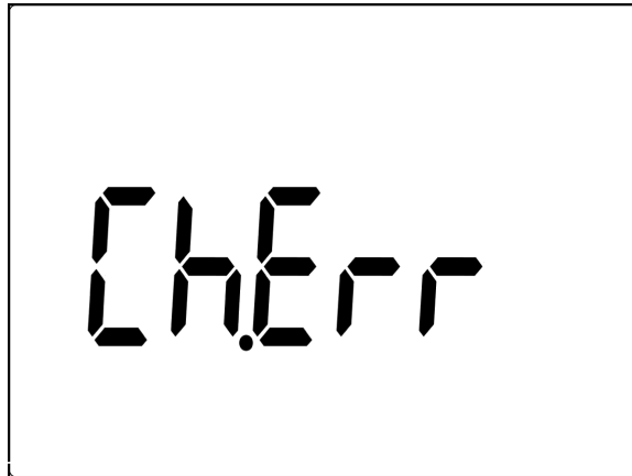
Figure 6-3 Alarme des bornes de charge
